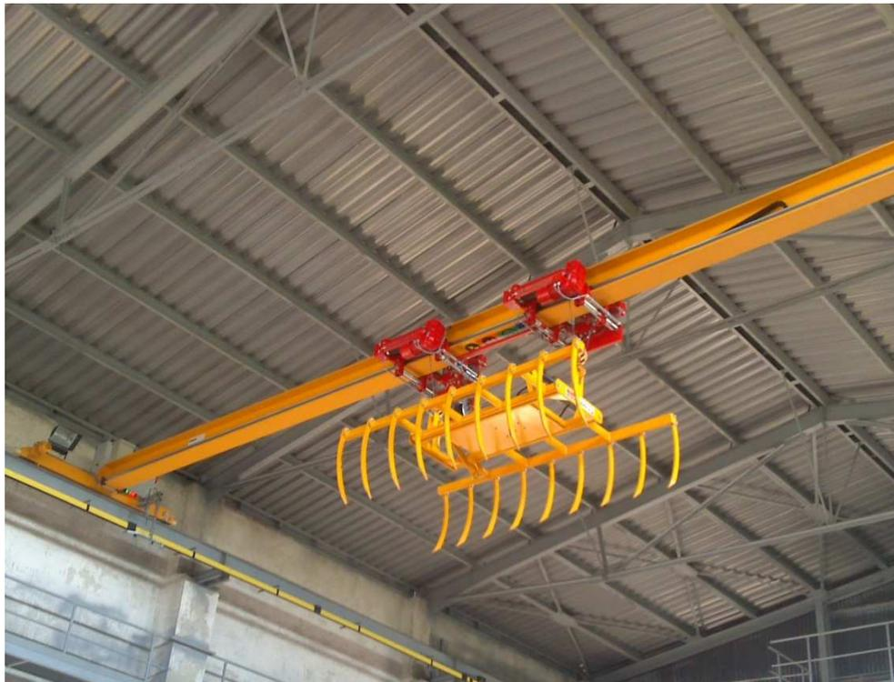
Частотное регулирование горизонтального привода для большинства грузоподъемных механизмов является достаточным элементом, который при правильном обслуживании обеспечит стабильность груза.
